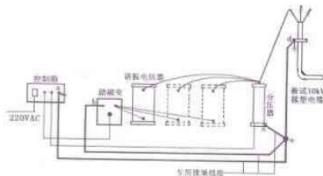
串联谐振试验现场接线布置原理示意图（单个或串并联使用）
