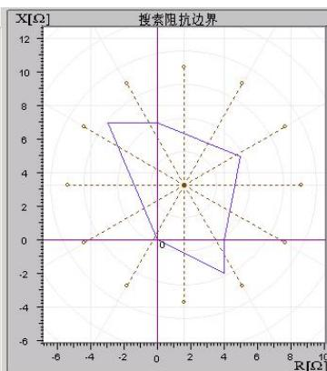
**绘制圆** 在上图中选择“圆”特性，在下面的表格中设置“整定阻抗”、“阻抗角度”以及“偏移量”等参数。右图中将实时显示其图形。用鼠标选中图形的中心，并在“搜索阻抗边界”页面中设置足够大的搜索半径及相应步长。如右图所示。
