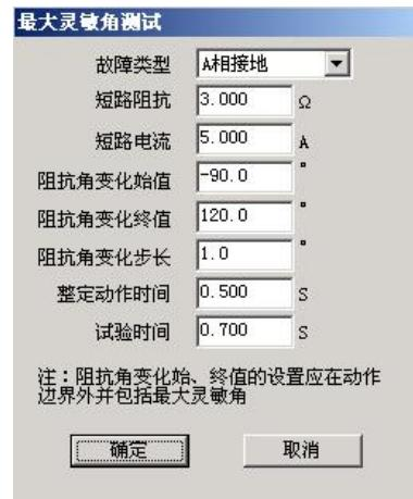
并且给定一个合适的变化步长就可以测出精度符合要求的最大灵敏角。
