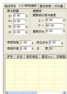
本试验的方法过程很像做差动继电器试验。如果把这里的阻抗比做差动试验的“制动电流”，则这里的电流就相当于“动作电流”。试验时，阻抗初始值为0，按一定的搜索步长增加。测试在每一个阻抗值下，保护的动作电流。测试完毕，软件会自动绘制出相应的曲线。“Z(V)特性曲线”参照“Z(I)特性曲线”。
