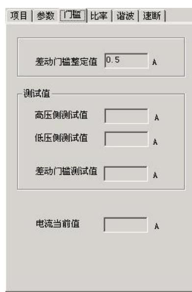
用正确接线侧的测试结果作为最终的“差动门槛测试值”。
