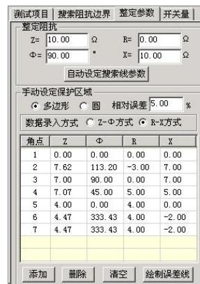
都可以设置为负数。各角点添加完后点击“画图”按钮，至此软件即绘出了理论的阻抗边界曲线以及相应的误差曲线（以虚线表示）。此时可用鼠标移至图形的中心位置点击鼠标左键，以设置扫描中心点，如右图所示。
