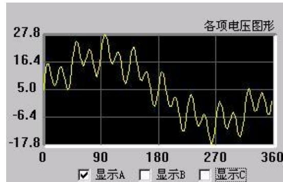
在同一个通道中叠加的波形有效值总和不能超过 120V (40A)。若超出范围，软件将给出超出范围提示，此时请检查输入数值或检查数据变化后总幅值是否已经超过了 120V (40A)。在数据输入时和输出变化中均要进行叠加幅值检查。
