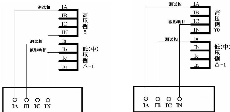
Y侧相位调整, 无零序修正, 按单相短路接线
