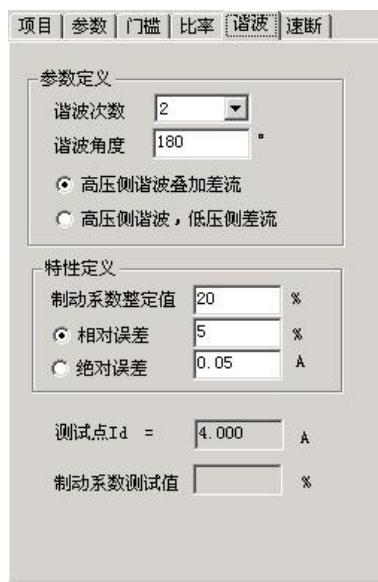
此时谐波分量为制动电流，基波分量作为差动电流。
