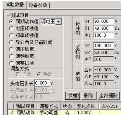
度摆入动作范围内，同期装置发出合闸命令（从装置的动作指示灯中能观察到）。手动或自动增、减待并侧电压至同期装置闭锁（在动作角差内不再动作）。自动变化时测试仪每次都朝电压差增大的方向改变待并侧电压，使压差逐步增大到同期装置不再动作（动作闭锁），即测得压差闭锁值。
