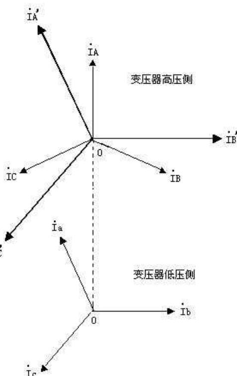
等，方向相反。试验时，为了平衡高压侧C相上的电流，就在低压侧的c相上加一补偿电流，并且，所加的补偿电流应与加在低压侧a相上的电流大小相等，方向相反。
