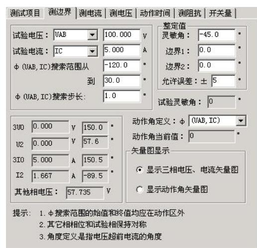
考虑到保护一般采用  $90^\circ$  接线方式，所以测试时也一般取线电压和第三相的相电流，如取电压  $U_{AB}$ ，电流  $I_C$ 。有时也可以选一相电压和一相电流进行试验，但一般不选线电流。注意，所选电压电流的值可以设定，但未被选择的各相电压值均等于额定电压，角度保持对称，未被选择的各相电流均为 0。
