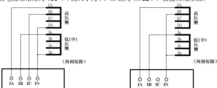
测试仪输出三路电流, IC 为补偿电流
