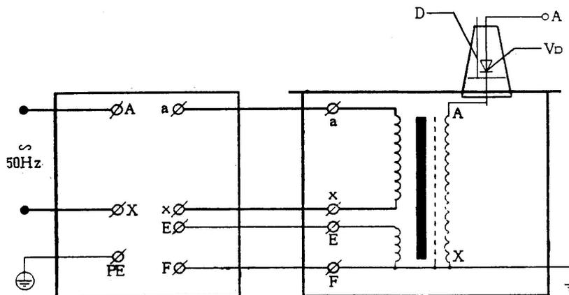
图四：YD(JZ)试验变压器的工作原理图
