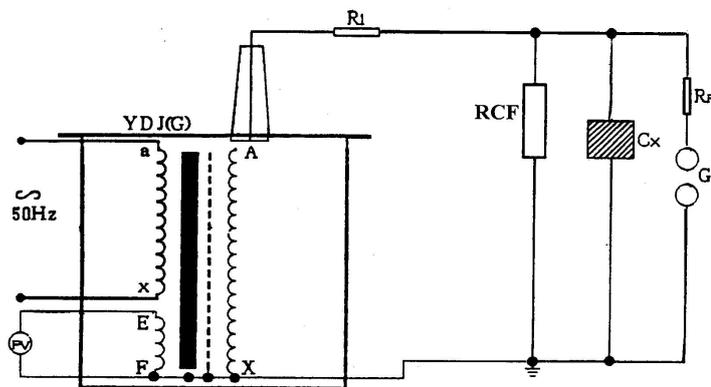
图 6：被试品工频耐压试验接线图
