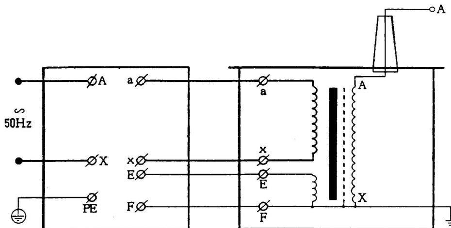
图三：单台 YD 试验变压器的工作原理图
