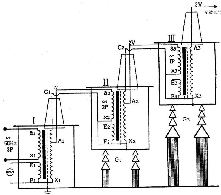
图五：三台试验变压器串级接线原理
