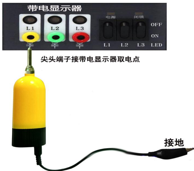
带电显示器核相示意图（图 3）
